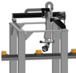
既存のコンベアラインに 設置可能なインライン装置構成例。
